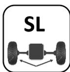
Il veicolo **rimane a due ruote motrici**. Incorpora un **differenziale anteriore a slittamento limitato di serie**: quando una delle ruote anteriori perde la trazione, il SL trasferisce parte della coppia all'altra ruota, permettendo al veicolo di uscire dalla situazione difficile in cui si trova.
