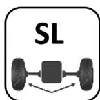
Il veicolo **rimane a due ruote motrici**. Incorpora un **differenziale anteriore a slittamento limitato QUAIFE® di serie**: quando una delle ruote anteriori perde la trazione, il GL trasferisce parte della coppia all'altra ruota, permettendo al veicolo di uscire dalla situazione difficile in cui si trova.
