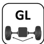
Le véhicule **reste en deux roues motrices**. Il intègre **de série un différentiel avant à glissement limité (GL)** : lorsque l'une des roues avant perd de l'adhérence, le GL transfère une partie du couple vers l'autre roue, permettant au véhicule de se sortir de la situation difficile dans laquelle il se trouve.
