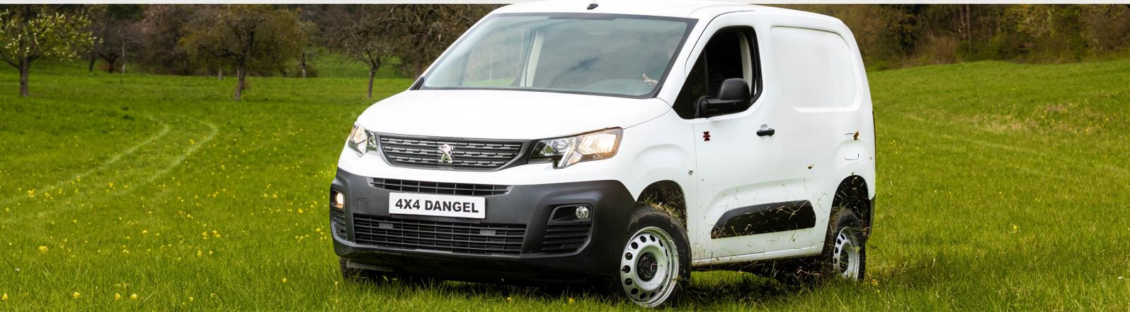
Der PARTNER 4x4 Dangel ist die ideale Lösung für sicheres Fahren unter schwierigen Bedingungen: Sobald der 4x4-Modus aktiviert ist und die Vorderräder die Bodenhaftung verlieren, verteilt das 4x4-System einen Teil der verfügbaren Kraft auf die Hinterräder, so dass das Fahrzeug weiterrollen kann. Dieser Vorgang erfolgt sofort, ohne dass der Fahrer eingreifen muss.
