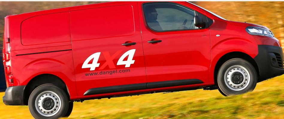
Der JUMPY 4x4 Dangel ist die ideale Lösung für **sicheres Fahren unter schwierigen Bedingungen**: Sobald die Vorderräder die Bodenhaftung verlieren, verteilt das 4x4-System einen Teil der verfügbaren Kraft auf die Hinterräder, so dass das Fahrzeug weiterrollen kann.
