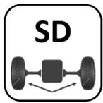
Das Fahrzeug **bleibt im Zweiradantrieb**. Wenn eines der Vorderräder die **Bodenhaftung verliert**, überträgt das Sperrdifferential (SD) einen Teil des Drehmoments auf das andere Rad und hilft dem Fahrzeug so, aus der schwierigen Situation herauszukommen.
