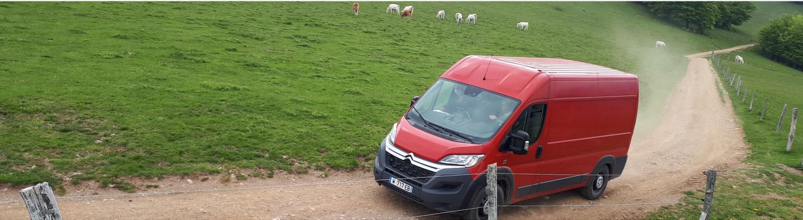
Der JUMPER 4x4 Dangel ist die ideale Lösung für **sicheres Fahren unter schwierigen Bedingungen**: Sobald die Vorderräder die Bodenhaftung verlieren, verteilt das 4x4-System einen Teil der verfügbaren Kraft auf die Hinterräder, so dass das Fahrzeug weiterrollen kann.
