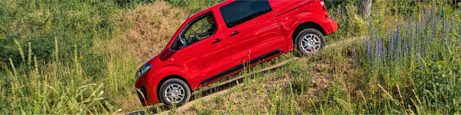
Il VIVARO 4x4 Dangel è la soluzione ideale per **una guida sicura in condizioni difficili**: non appena le ruote anteriori perdono aderenza, il sistema 4x4 distribuisce parte della potenza disponibile alle ruote posteriori, permettendo al veicolo di continuare il percorso. Questa modulazione avviene istantaneamente, **senza alcun intervento da parte del conducente**.
