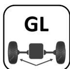
Le véhicule **reste en deux roues motrices**. Il intègre **de série un différentiel avant à glissement limité (GL)** de la marque QUAIFE®, LA référence dans le domaine : lorsque l'une des roues avant perd de l'adhérence, le GL transfère une partie du couple vers l'autre roue, permettant au véhicule de se sortir de la situation difficile dans laquelle il se trouve.
