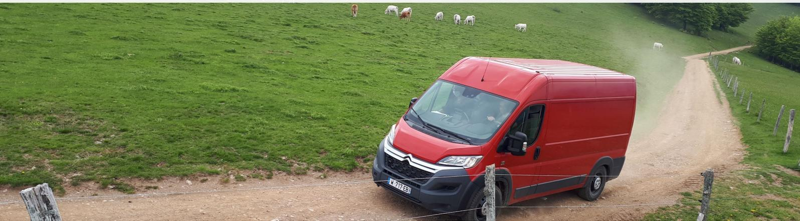
Il JUMPER 4x4 Dangel è la soluzione ideale per **una guida sicura in condizioni difficili**: non appena le ruote anteriori perdono aderenza, il sistema 4x4 distribuisce parte della potenza disponibile alle ruote posteriori, permettendo al veicolo di continuare il percorso. Questa modulazione avviene istantaneamente, **senza alcun intervento da parte del conducente**.
